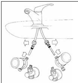
Inserire sui tubi di rame i raccordi rimossi precedentemente dai rubinetti d'intercettazione.
