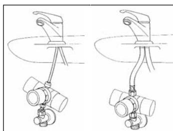
Gli attacchi disposti radialmente al pistone ammortizzatore consentono la rotazione dello stesso a seconda delle necessità di spazio.
