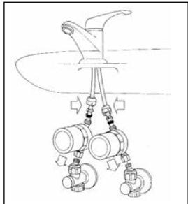
Piegare i tubi di rame verso l'interno, fino ad allineare l'attacco inferiore degli ammortizzatori con gli attacchi dei rubinetti d'intercettazione, quindi avvicinare e serrare sia la calotta mobile dell'ammortizzatore sui rubinetti che il raccordo superiore sul tubo del sanitario all'ammortizzatore.
